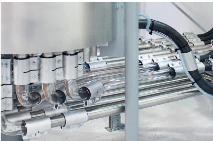
oberfläche der Rohre bewirkt, dass das Fördergut während des Transports in Turbulenzen gerät und nicht an der Rohrwand entlang rutscht. Der verminderte Kontakt zwischen Fördergut und Rohr schont beide.
