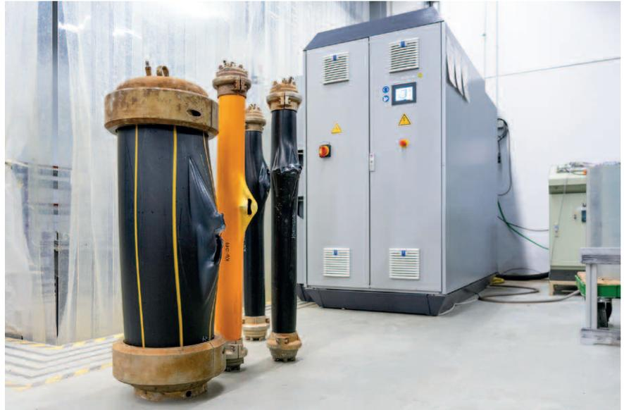
Geprüfte Rohre vor dem neuen Großrohr-Berstprüfgerät
