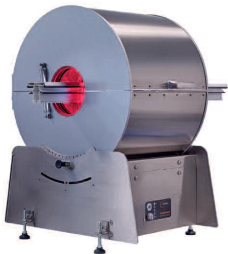
Die kostenoptimierten Downsized-Modelle der Kompaktserie iProfilControl für die Profilüberwachung bieten maximale Prüfperformance zum attraktiven Preis – und das auch als Standardlösung für die Inspektion von Großprofilen bis 250 mm Durchmesser
